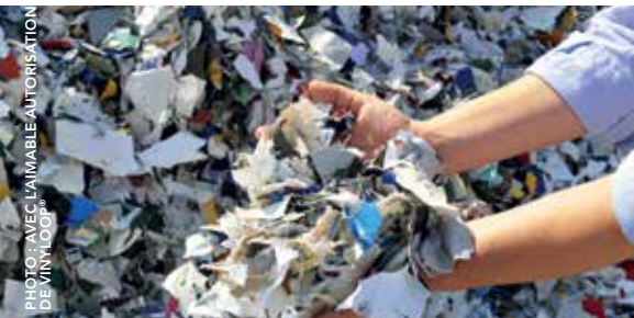
Déchets de tissus enduits PVC de Serge Ferrari destinés au recyclage à l'usine VinyLoop® de Ferrare en Italie
